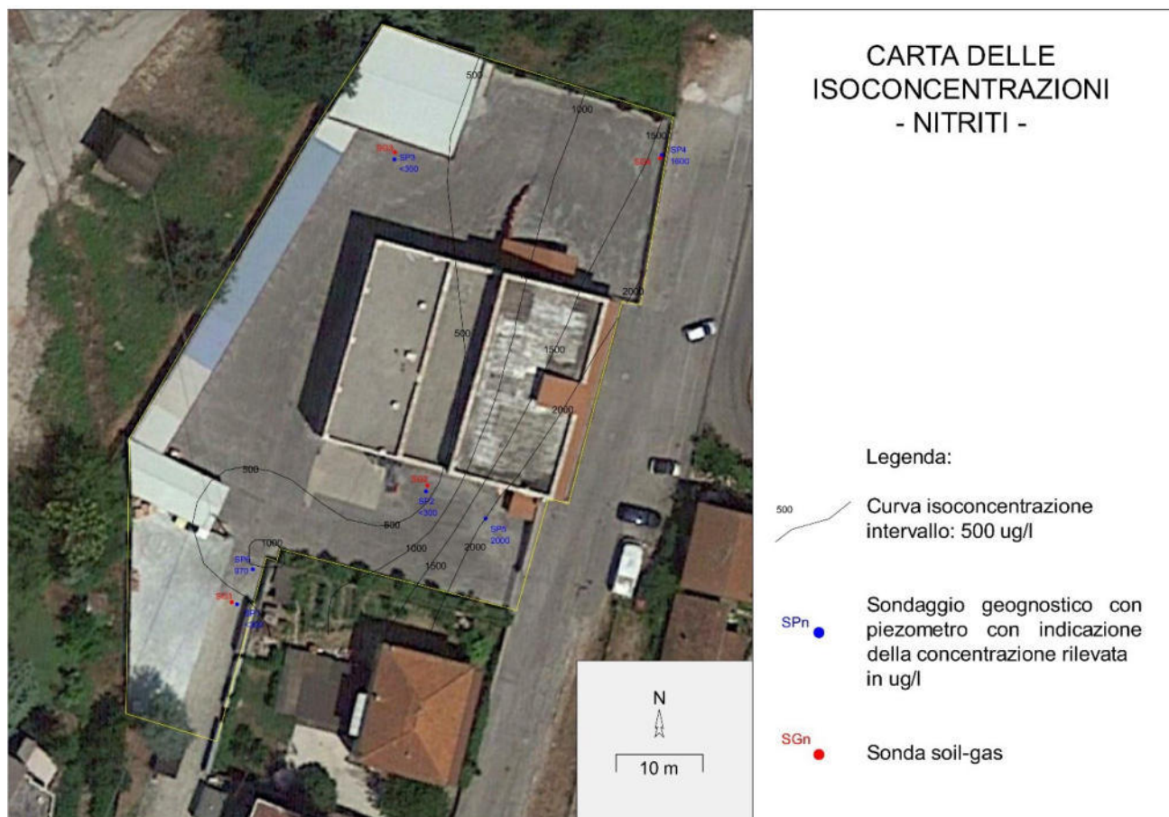
Figura 15 – Carta delle linee di isoconcentrazione “nitriti”
